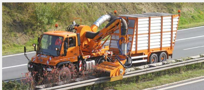
Travailler au-dessus d'une barrière d'autoroute avec HSK 1200
