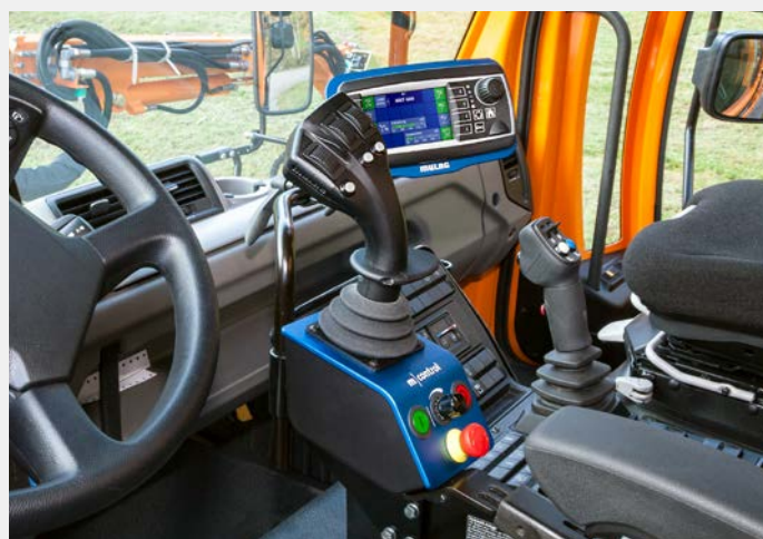
Joystick multifonctions m|pilot avec commande 6 fonctions proportionnelles
