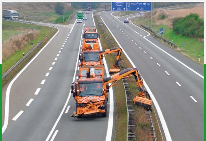
Faucheuses-débroussailleuses arrière avec système de ramassage de l'herbe
